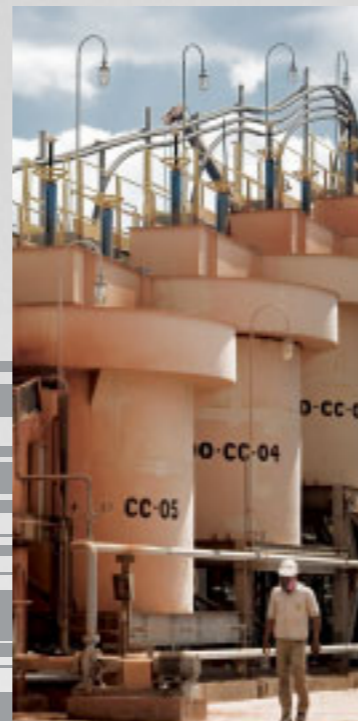
Conjunto de colunas de adsorção Yamana - MT Set of adsorption feed head tank
