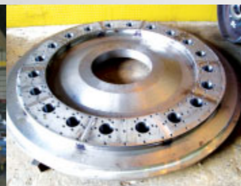
Distribuidor para geração de energia Energ Power - Usina Salto Curuá - MT Distributor for energy generation
