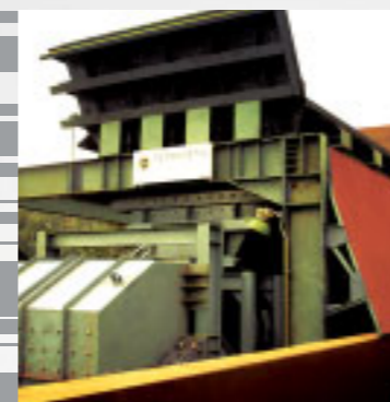
Moega e alimentador CVRD - PA Hopper and feeder
